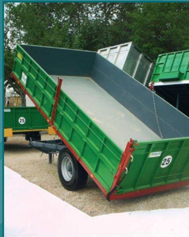
Remolque doble basculante, portón hidráulico.
