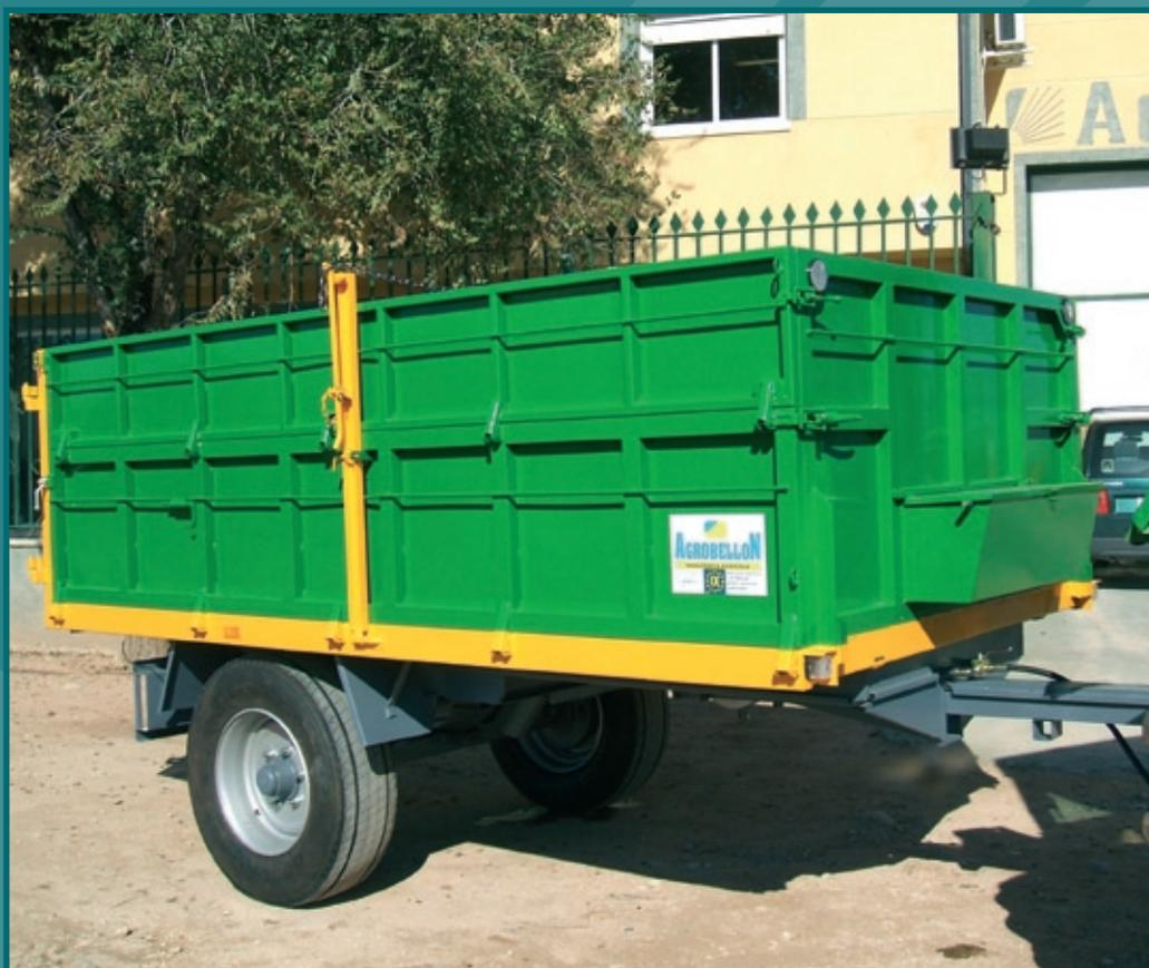
Pintado en cabina secado de horno y tratamiento especial anticorrosión.
